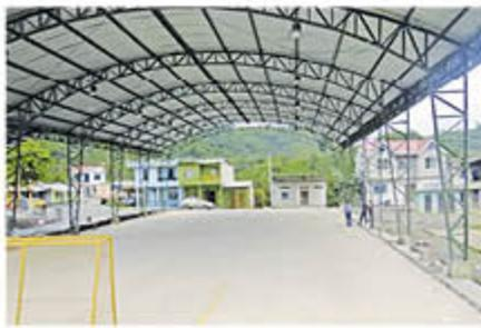
Con una inversión de USD. 6.916,48 la cancha de la comunidad Gramalote fue reconstruida y contempla trabajos de: Fundición de la losa de conformación de la cancha, pintura, canal de recolección y drenaje de agua lluvia.
